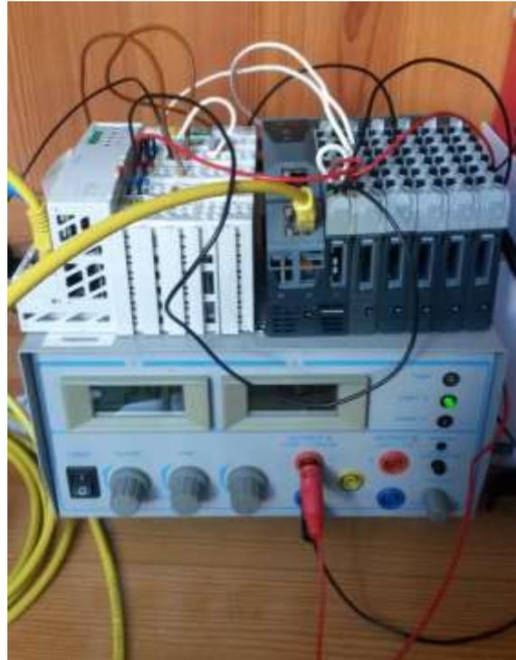
Abbildung 12: Versuchsaufbau mit den beiden Busklemmen und der Energieversorgung
